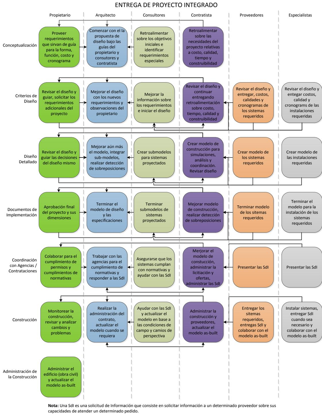
**Figura 5.2:** Flujo de Taras para el procesos de colaboración en distintas etapas de un proyecto bajo la modalidad diseño de proyecto Integrado. (Autodesk, 2010)
